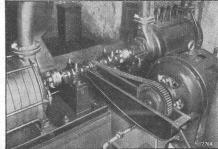
Vollständig ruhiger Antrieb eines Rotationskompressors bei 4320 Touren pro Minute.
