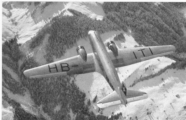
Abb. 2. Douglas DC 2 der „Swissair“; Spannweite 26 m, Rumpflänge 19 m.
