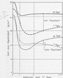
Abb. 3. Haft bezw. Biegefestigkeiten von Beton ohne und mit Plastimentzusatz.
