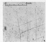
Abb. 2. Oberflächen-Struktur von PZ 300 plastisch, links ohne und rechts mit Plastimentzusatz. Das Vorhandensein bezw. Fehlen der Schlammschicht ist durch Ritzen der Oberfläche veranschaulicht.
