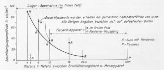
Abb. 1. Beschleunigungswerte in cm·sec-2 für die Vertikalkomponente der Erschütterung in Abhängigkeit von der Distanz zwischen Erschütterungsherd und Messapparat.
