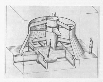
Abb. 5. Skizze der Anordnung nach dem Umbau. Alle Hindernisse verkleidet, grosser Abstand des Rades vom Hindernis. Bessere Luftführung durch den Blechmantel (mit verkleideten Radialstützen).
