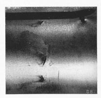
Abb. 11. Bruchausgangstellen seitlich der Keilnut als Folge des Scheuerns der Schwungmassen. (Stab 632; statisch aufgeweitet.)
