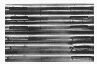
Abb. 12. Stäbe in der Nutenanordnung 120-0-70, bei denen ein einwandfreier Erfolg des Oberflächendrückens erzielt wurde. Links ungedrückte, rechts gedrückte Keilnuten. Vorderansicht.
