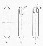
Abb. 14. a alter Keil; b neuer Keil für Passfederverbindung; c neuer Keil mit Anzug.
