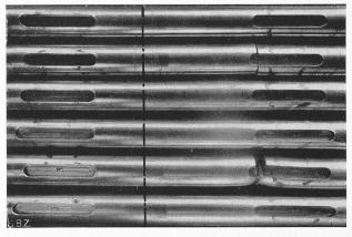
Abb. 13. Stäbe in der Nutenanordnung 120-0-70, bei denen ein einwandfreier Erfolg des Oberflächendrückens erzielt wurde. Links ungedrückte, rechts gedrückte Keilnuten. Rückansicht.
