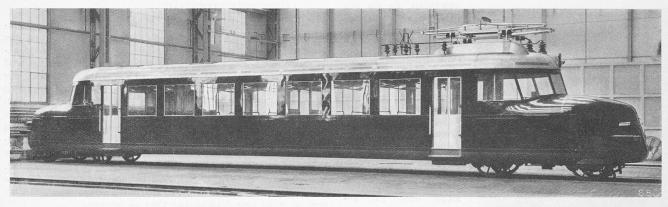
Leichttriebwagen für elektrifizierte Strecken der SBB. - 350 PS, Tara 30 t, 70 Sitze, Sitzplatzgewicht 430 kg, vmax 125 km/h.
