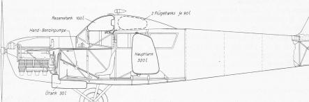
Abb. 5. Dreiplätziges Sportflugzeug AC 12 von A. Comte, Horgen, für Langstreckenflug ausgebaut durch W. Farner, Flugzeugbau Grenchen. — 1:50.
