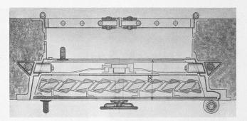
Abb. 1. Panzertüre mit Gaszellen der Union-Kassenfabrik Zürich. - Masstab 1:15.
