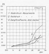
Abb. 2. Entwicklung der Einheitsleistung der Drehstromgeneratoren.
