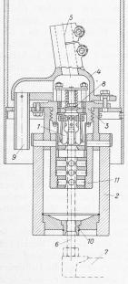
Abb. 8. Schnitt einer Löschkammer.
