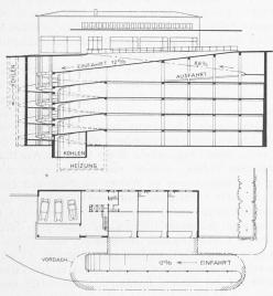
Abb. 8. Grossgarage Kasinoplatz. – Masstab 1:800. Grundriss vom Erdgeschoss und Längsschnitt durch die Einfahrt.
