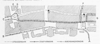
Abb. 12. Schema der Verkehrsführung nach Vorschlag Thommen mittels durchgehendem strassenbahnfreiem Strassenzug Schauplatz-Amthaus-Kesslergasse nach der Unterstadt.
