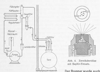
Abb. 6. Schema des Oelumlaufs.
