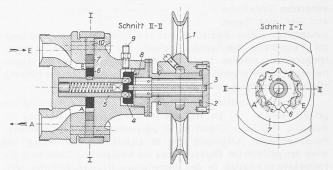
Abb. 5. Stopfbüchsfreie Gerotor-Oelpumpe.
