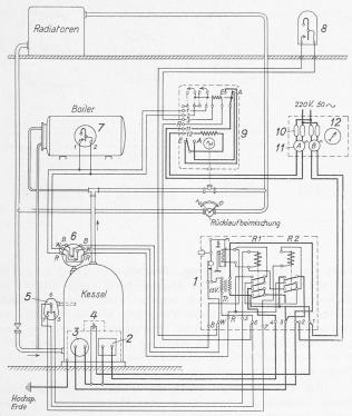
Abb. 3. Elektr. Schaltschema der vollautomatischen Regulierung.
