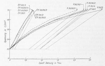
Abb. 4. Spannungs-Dehnungs-Diagramme verschiedener Gusseisensorten.
