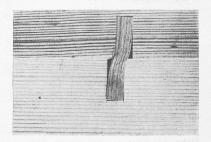
Abb. 3. Versuchsbelastung mit Hartholzplättchen.
