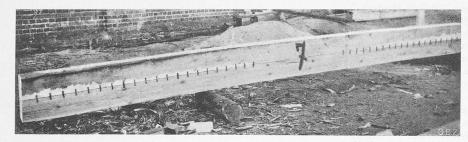
Abb. 1. Mit Hartholzplättchen unter Vorspannung verdübelter, unverbolzter Balken, System Derewiagin.
