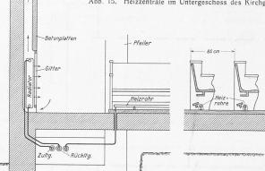
Abb. 16. Kirchenheizung durch Wandradiatoren und Fussbankrohre. -1:60.
