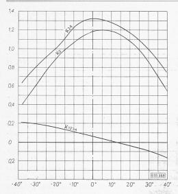
Abb. 3. Eichkurven der Staukugel.
