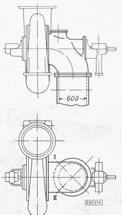
Abb. 4. Bestimmung der Fördermenge einer Pumpe durch Geschwindigkeitsmessung in den Messebenen I und II der Saugleitung
