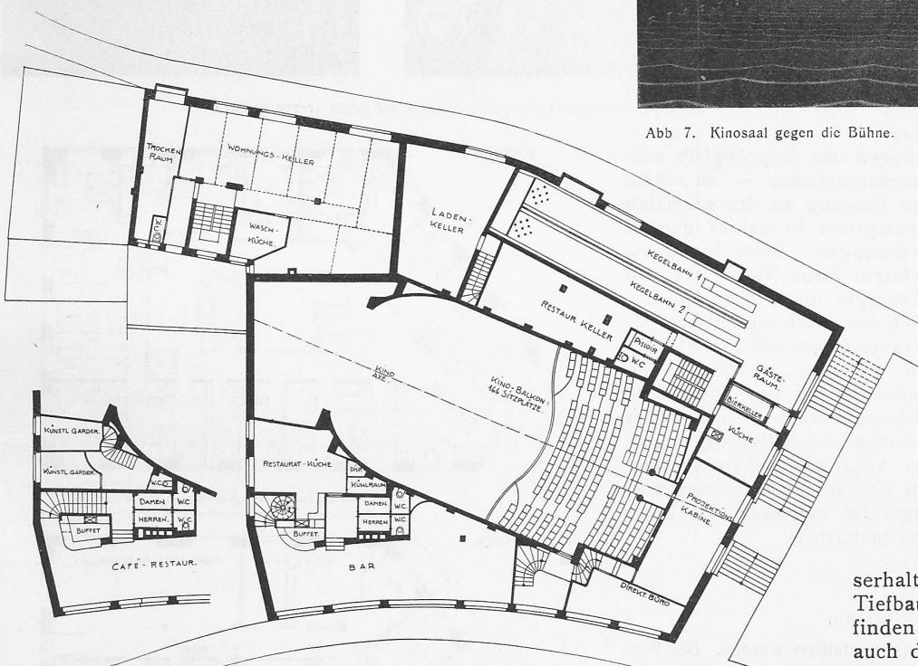
Abb. 1. Grundriss Unter- und Zwischengeschoß, 1 : 400. Abb. 1 bis 3 Clichés aus „Hoch- u. Tiefbau“.
