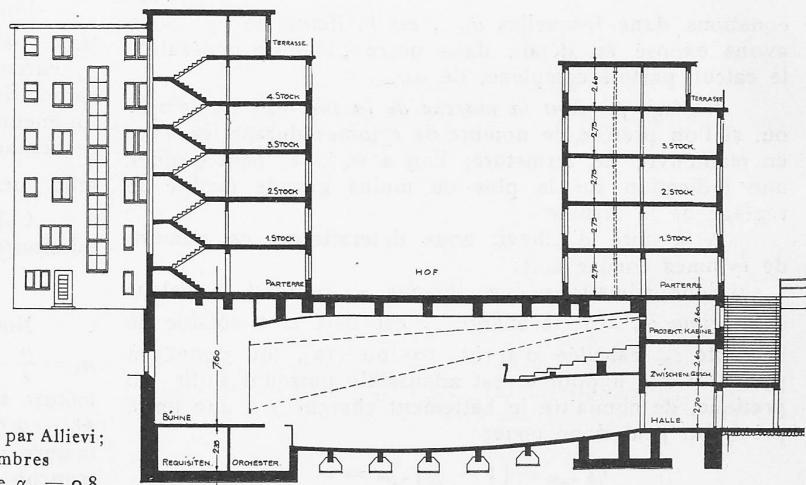
Abb. 3. Längsschnitt 1 : 400 in der Axe des Kinosaales.
