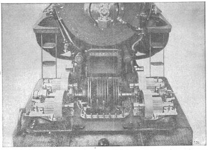
MAAG-REDUKTIONSGETRIEBE FÜR TURBOLOKOMOTIVE MAFFEI, 2000 PS; 7220/320 U/Min., Verzahnung gehärtet und geschliffen, geliefert 1927, abgeändert nachbestellt 1933.
