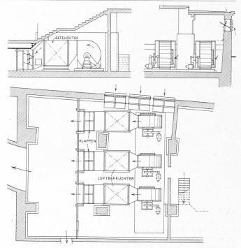
Abb. 27. Die Lüftungsanlage im Textilwarenhaus OBER in Zürich. — 1:200.
