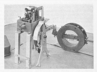
Abb. 6. Elektrischer Antrieb der Einlaufklappe.
