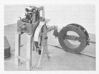
Abb. 6. Elektrischer Antrieb der Einlaufklappe.
