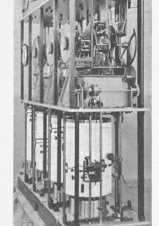
Abb. 3. Registrierende Wasserstand-Empfänger.
