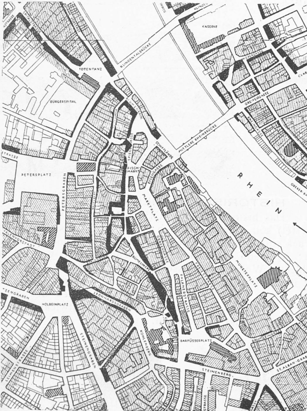
Ausschnitt 1: 10 000 aus dem Basler Stadtkorrekionsplan. Schwarz = abzubrechende Bauteile. Die Verbreiterung der aus dem Mittelalter stammenden Strassenzüge trifft eine grosse Zahl von Liegenschaften, die zudem oft eine für eine gute Ueberbauung ungünstige Form erhalten.
