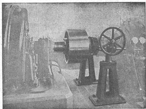
Benn-Kupplung zur Übertragung von 3000 PS bei 1000 Umdrehungen in der Minute in einer Akkumuliereranlage.
