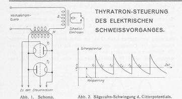
spannungsklemmen eines Hilfstransformators H anschliessen, dessen Niederspannungswicklung im Primärkreis des Schweisstransformators liegt. Auf gleich zu beschreibende Weise gelingt es, H periodisch durch die Röhren kurzzuschliessen. Jeder Kurzschluss bewirkt einen Stromstoss in dem Primär- und damit in dem durch das Schweissgut geschlossenen Sekundärkreis des Schweisstransformators, jedes Oeffnen der Thyratron-Ventile ein Versiegen dieser Ströme.
