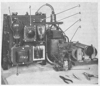
Abb. 3. Thyratron-Apparatur für Punktschweissung (1 kVA), Deckel abgehoben.
