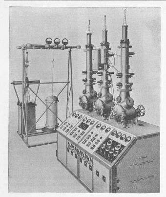
Abb. 1. Dreipoliger Kathodenstrahl-Oszillograph von Trüb, Täuber & Co., Zürich.
