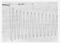
Abb. 2. Schwingung eines Stahlbandes.
