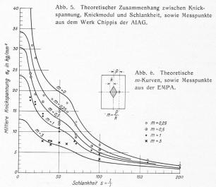
Bei gegebenem Querschnitt ist der Knickmodul durch E und T bestimmt; z. B. folgt aus (1) und (2) für rechteckige Stäbe:
