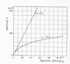
Abb. 13. (Mangan-Gusstahl.)
