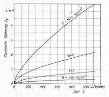
Abb. 11. (Mangan-Gusstahl.)
