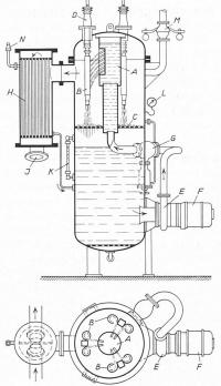
Abb. 13 u. 14. Brown-Boveri-Elektrokessel, Ansicht und Schema. Legende: A Strahlrohr, B Elektroden, C Gitterblech, D Stromdurchführung, E Umwälzpumpe, F Antriebsmotor zur Umwälzpumpe, G Leistungsregulierventil mit automatischem Druckregler, H Badewasservorwärmer, J Badewasser-Ein- und Austritte, K Wasserstandsanzeiger, L Manometer, M Sicherheitsventile, N Entlüftungsventil.
