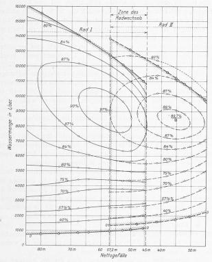
Abb. 13. Betriebcharakteristik der Modellturbine für die grossen Turbinen Jándula.
