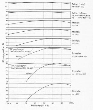
Abb. 3. Wirkungsgrad-Diagramme moderner Bell-Wasserturbinen.
