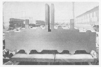
Abb. 5. Gurtungs-Versuchstück mit Niet- und Bolzenverbindungen.
