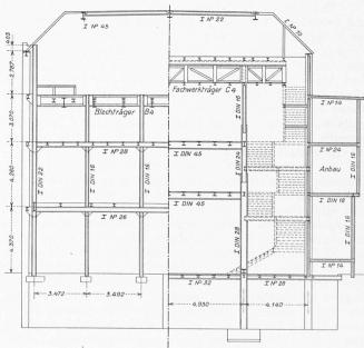
Abb. 21. Binderebenen B und C (vergl. Abb. 12 u. 14). — 1:250.
