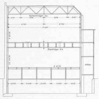
Abb. 20. Schnitt in Binderebene A (vergl. Abb. 12 u. 14). - 1:250.
