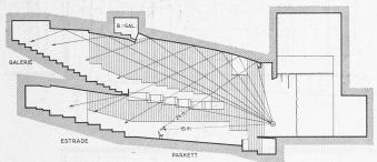
Abb. 8. Raum-Längsprofil, mit den Hauptschallstrahlen. — 1:500.
