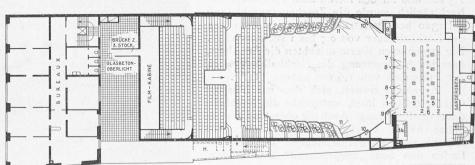
Abb. 11. Grundriss vom 2. Geschoss: Galerie, Balkon und Logen; Bühnenbeleuchtung (Legende vergl. Abb. 14).
