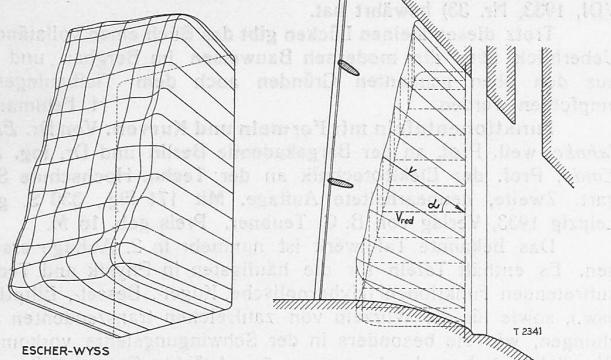
Links: Axometrische Darstellung der für einen Vollastpunkt gemessenen Wassergeschwindigkeiten. — Rechts: Aufriß des Einlaufs mit eingezeichneten Strömungsrichtungen und Geschwindigkeiten. Schematische Angabe zur Berechnungweise der Wassermenge.
