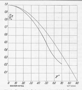
Abb. 3. Theoretische Cosinuskurve und tatsächliche Eichkurve eines Ott-Speichenflügels bei schrägem Anströmen. (Eichung vom Mai 1933 im Eichkanal von Ott in Kempten.)  $n_o=$  Geschwindigkeit,  $n_{arphi}=$  deren Komponente in Richtung der Flügelaxe,  $\varphi = \text{Anströmwinkel.}$
