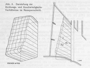
Links: Axometrische Darstellung der für einen Vollastpunkt gemessenen Wassergeschwindigkeiten. — Rechts: Aufriss des Einlaufs mit eingezeichneten Strömungsrichtungen und Geschwindigkeiten. Schematische Angabe zur Berechnungsweise der Wassermenge,
