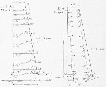
Abb. 2 (links) Hauptspannungs-Trajektorien. Abb. 3 Hauptspannungen, Abb. 4 Randspannungen einer am Fuss eingespannten Stützmauer mit einseitigem Anzug.
