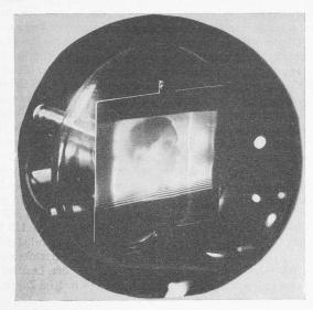
Abb. 4. Fluoreszenzbild eines Fernseh-Empfängers.
