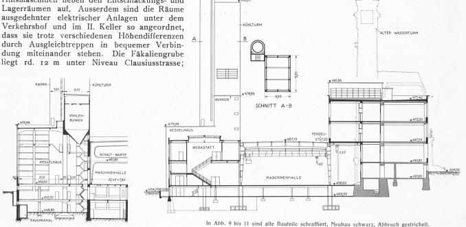
Abb. 8. Schnitt durch das Kesselhaus. - Masstab 1:600.
