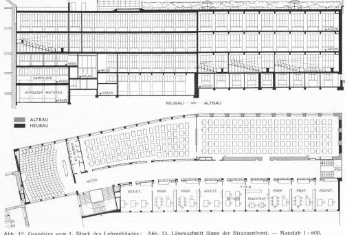
Abb. 12. Grundriss vom 1. Stock des Lehrgebäudes; Abb. 13. Längsschnitt längs der Strassenfront. — Masstab 1:600.
