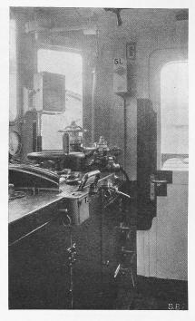
Abb. 13. Lokomotiv-Führerstand mit Wachsamkeitstaste WT und Signallampe SL.
