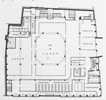
Abb. 1. Kellergeschoss. - Masstab 1:600.
