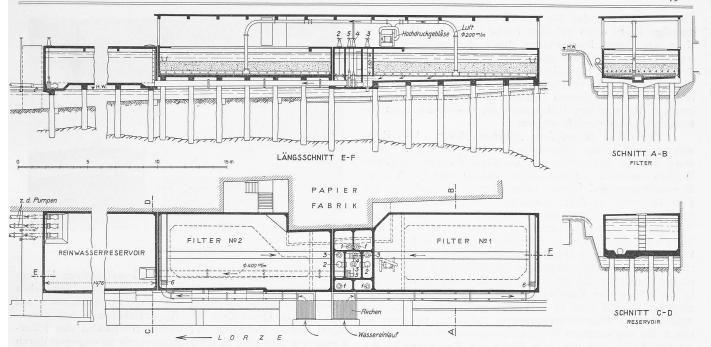
Abb. 2. Offene Schnellfilter nach "System Peter" für die Brauchwasser-Versorgung der Papierfabrik Cham. — Horizontal- und Vertikalschnitte, Masstab 1: 250. 1 Spühlwasser-Entleerung, 2 Reinwasser-Regulatoren, 3 Reinwasser-kammer-Entleerung, 4 Rückspühl-Schieber, 5 Reinwasser-Schieber, 6 Rohwasser-Regulierung,
