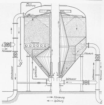
Abb. 2 System Bollmann. - Geschlossene Schnellfilter. - Abb. 3 System Häny.
