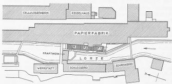
Abb. 1. Lageplan der Schnellfilter-Anlage der Papierfabrik Cham, 1:2000. F1 und F2 = Filterkammern, R = Reinwasser-Reservoir.
