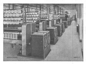
Antrieb von doppelten Baumwoll-Ringspinnmaschinen mit Dreiphasen-Kommutatormotoren.
