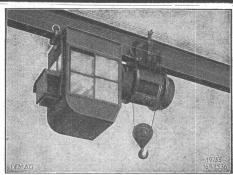
5000 kg-Zug mit elektrischem Fahrwerk und angekuppeltem Steuerhaus
