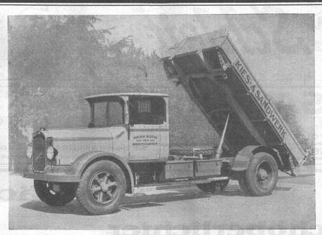
Für grosse Erdaushübe und Baumaterialtransporte sind unsere hydraulischen Dreiseitenkipper unübertroffen. Sie besitzen alle den widerstandsfähigen Berna-Ritzelantrieb mit grosshubigem Benzin- oder Rohölmotor 70 und 80 PS.
