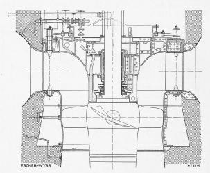
Abb. 3. Kaplan-Turbine (mit 23,21 m Gefälle) der Escher Wyss Maschinenfabriken für das Limmatkraftwerk Wettingen. — Vertikalschnitt 1:66,7. (Die Clichés zu Abb. 3 bis 5 sind von der EWAG frdl. zur Verfügung gestellt.)
