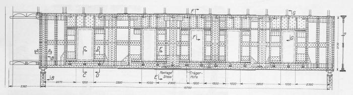
Abb. 8. Ansicht des genieteten Blechbalkenträgers von 3730 mm Höhe und 19760 mm Stützweite. — Masstab 1:120.
