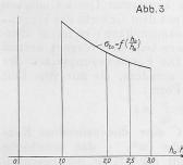
Die hierdurch gegebene Abhängigkeit der Tangentialspannung an der Bohrung vom Verhältnis  $2h_0: 10,0$  ist in Abb. 3 graphisch dargestellt. Für  $2h_0: 10,0 = 1,0$  ist die Ordinate des Diagramms aus den bekannten Formeln für die Scheibe konstanter Dicke berechnet  $h_0:h_0$  worden.
