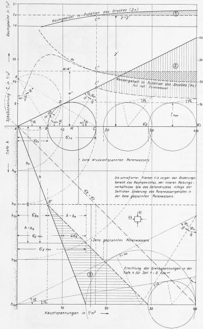
Abb. 7. Seitendruck in kohärenten, wassergesättigten Erdmassen.
