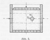
druck proportional. Aus der Verlängerung des äussern Durchmessers dieses Ringes kann nach erfolgter Eichung des Instrumentes auf die Grösse des Seitendruckes geschlossen werden. Die Eichung selbst würde dadurch erfolgen, dass man eine reibungslose Flüssigkeit, z. B. Wasser, in einer Gummihaut in den Zylinder einbringt und nun für verschiedene Drücke die Dehnung des Mittelstückes bestimmt. Bei der
