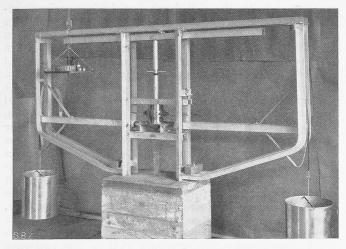
Abb. 1. Apparat Gruner-Häfeli für Schubversuche mit verdichteten Bodenarten im Bauplatz-Laboratorium des Kraftwerks Albbruck-Dogern.
