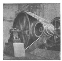
Antrieb eines Kompressors, 125 PS.
